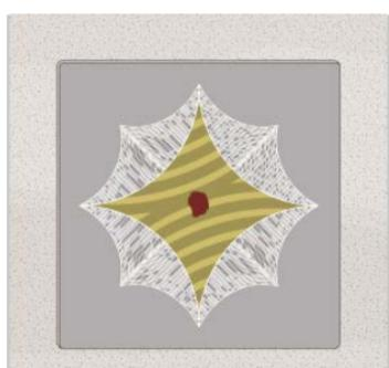
Отогнуть края сетки и удалить с поверхности каменной ваты загрязнённый участок.
