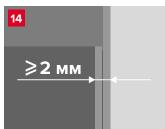
ВАЖНО! Толщина каждого нанесенного слоя не должна превышать 1,5 мм. Общая толщина гидроизоляции после высыхания мастики должна составлять не менее 2 мм
