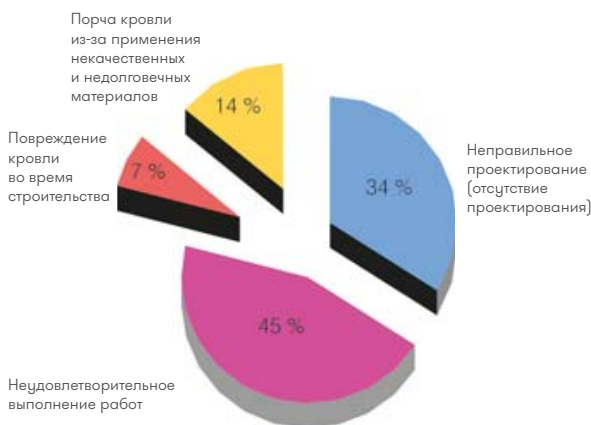
Рис. 1 Процентное соотношение кровельных повреждений.
