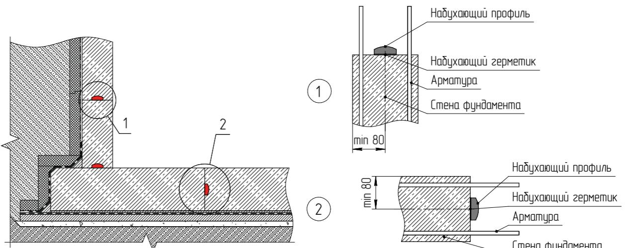
**4.3.** Монтаж и установку гидрошпонок необходимо производить в соответствии с проектно-конструкторской документацией.
