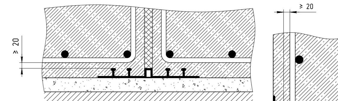
Гидрошпонки следует размещать строго симметрично относительно оси деформационного шва с внешней стороны монолитных конструкций.
