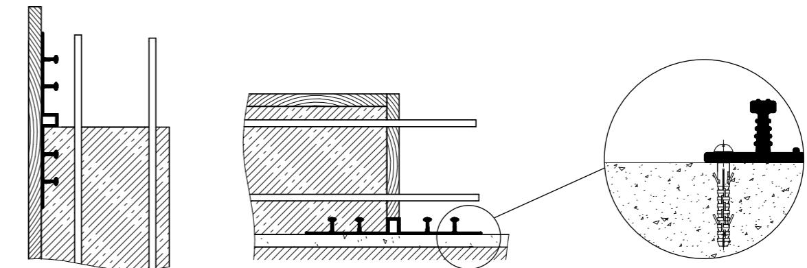
**4.15.** Внутренняя ПВХ гидрошпонка с набухающими шнурами **IC-125-2-SP** устанавливается на верхний ряд арматуры фундаментной плиты и крепится специальным омега профилем, который поставляется совместно с гидрошпонкой.
