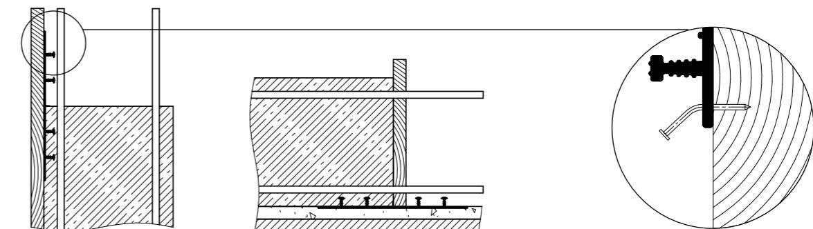
Крепление наружных гидрошпонок для деформационных швов. Стены и плита фундамента.
