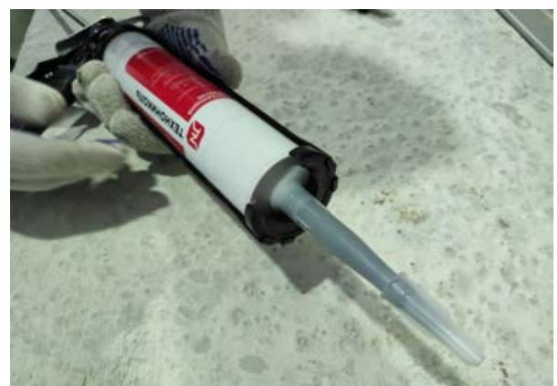
Подготовьте к работе пистолет для герметика. Для этого вложите тубу в пистолет и закрепите его корпус.
