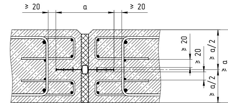
Гидрошпонки должны устанавливаться в середине плиты. Ось центра гидрошпонки должна совпадать с осью деформационного шва.
