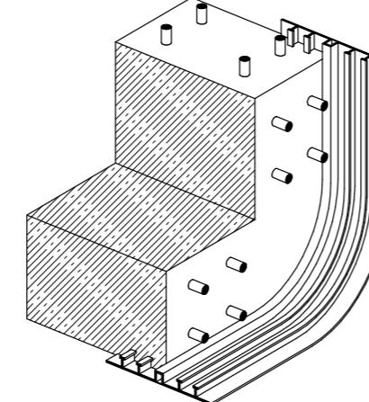
При невозможности обеспечить допустимый радиус изгиба следует выполнять сварной монтажный стык гидрошпонки с заданным углом поворота.
