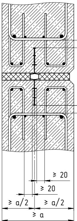
Гидрошпонки следует размещать строго симметрично относительно осей шва.
