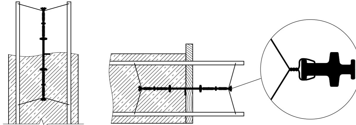
Крепление внутренних гидрошпонок для деформационных швов. Стены и плита фундамента.
