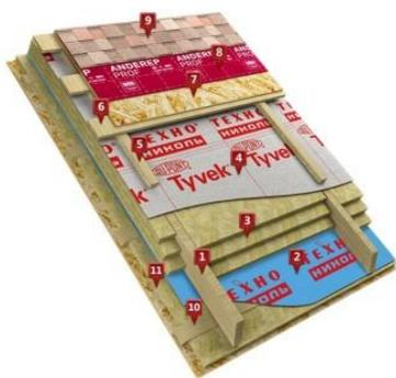
1. Деревянная стропильная система 200 мм
