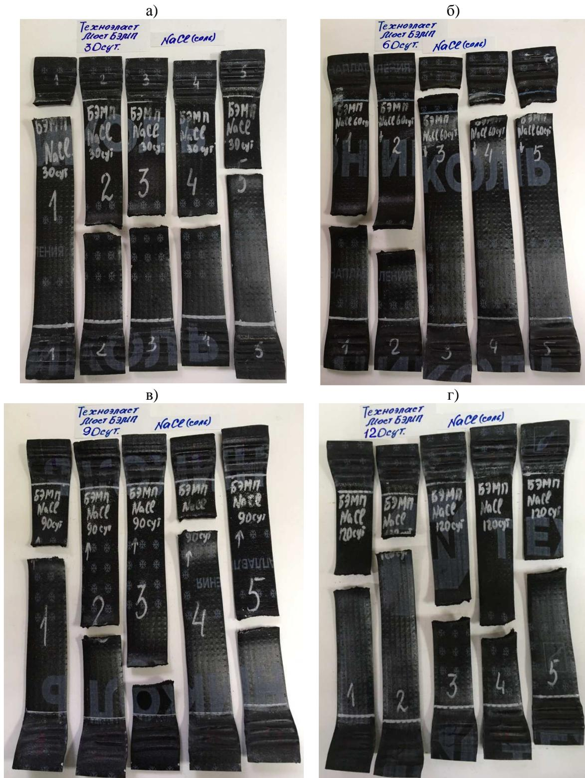
Рисунок 5 – Испытанные образцы рулонного гидроизоляционного материала **ТЕХНОЭЛАСТМОСТ Б** по определению его деформативно-прочностных показателей после воздействия на него **NaCl (насыщенный раствор)** в течение 30 (а), 60 (б), 90 (в) и 120 (г) суток
