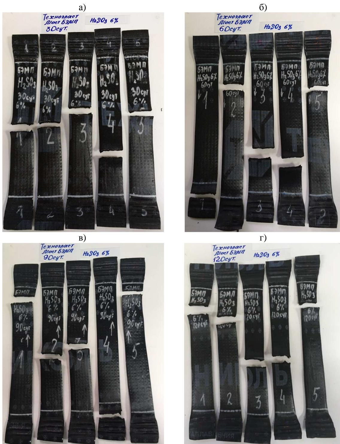
Рисунок 8 – Испытанные образцы рулонного гидроизоляционного материала **ТЕХНОЭЛАСТМООСТ Б** по определению его деформативно-прочностных показателей после воздействия на него **H<sub>2</sub>SO<sub>3</sub> (6 %)** в течение 30 (а), 60 (б), 90 (в) и 120 (г) суток
