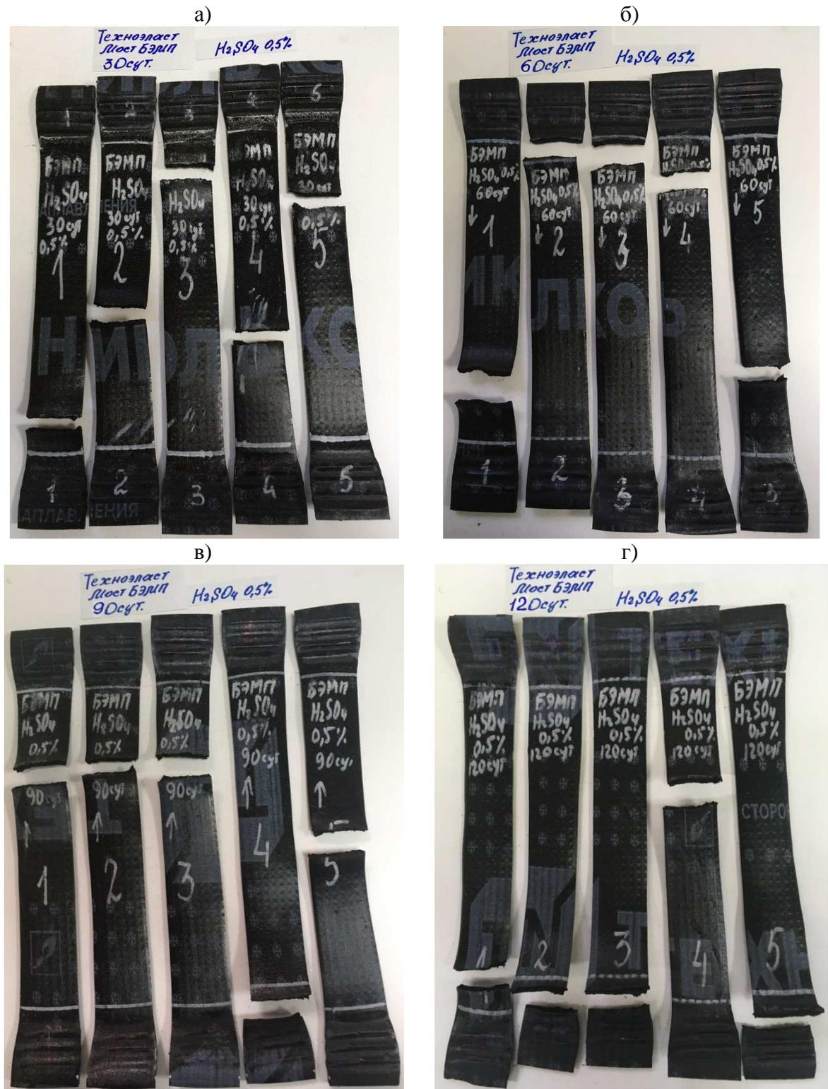
Рисунок 9 – Испытанные образцы рулонного гидроизоляционного материала **ТЕХНОЭЛАСТМОСТ Б** по определению его деформативно-прочностных показателей после воздействия на него **H<sub>2</sub>SO<sub>4</sub> (0,5 %)** в течение 30 (а), 60 (б), 90 (в) и 120 (г) суток
