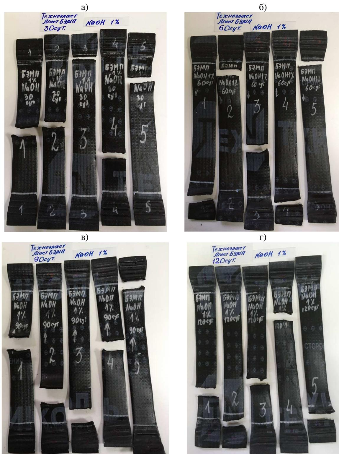
Рисунок 7 – Испытанные образцы рулонного гидроизоляционного материала **ТЕХНОЭЛАСТМОСТ Б** по определению его деформативно-прочностных показателей после воздействия на него **NaOH (1 %)** в течение 30 (а), 60 (б), 90 (в) и 120 (г) суток
