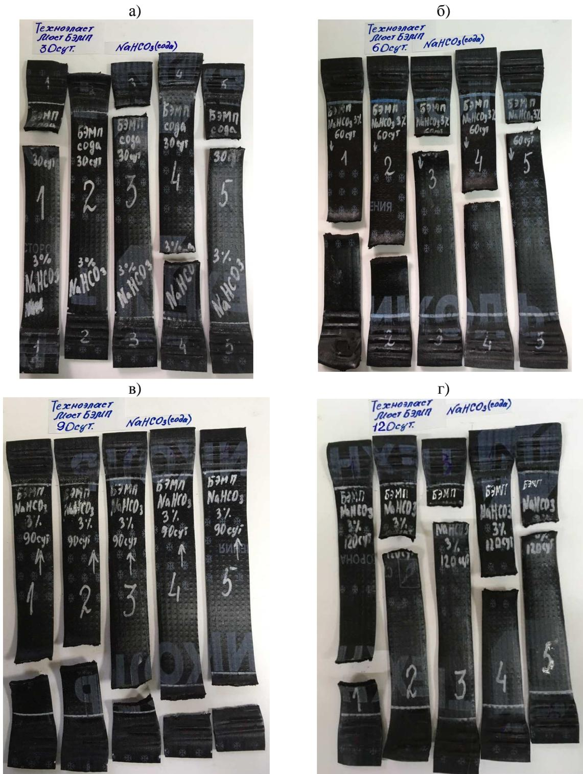
Рисунок 4 – Испытанные образцы рулонного гидроизоляционного материала **ТЕХНОЭЛАСТМОСТ Б** по определению его деформативно-прочностных показателей после воздействия на него **NaHCO<sub>3</sub> (3 %)** в течение 30 (а), 60 (б), 90 (в) и 120 (г) суток
