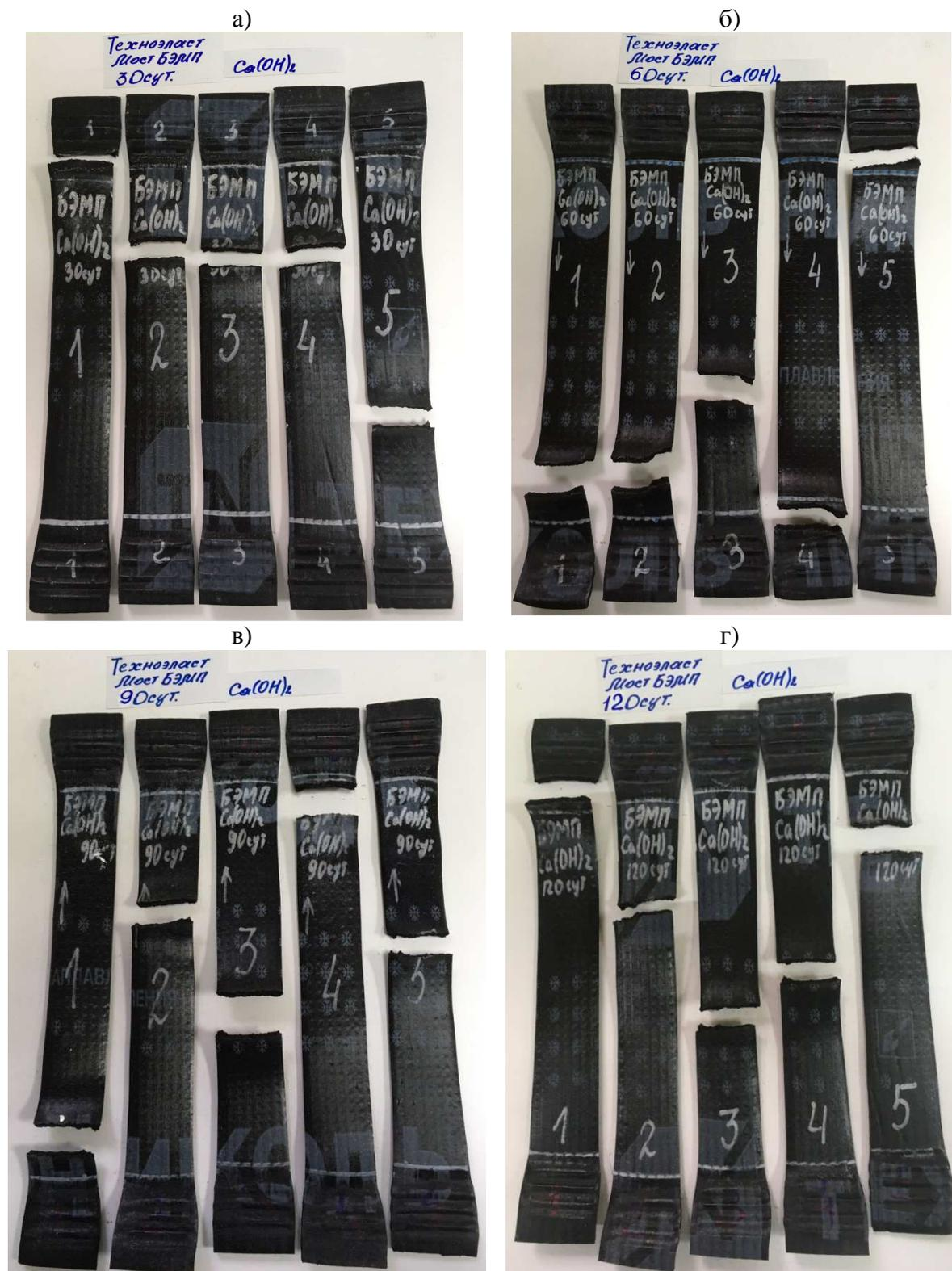
Рисунок 6 – Испытанные образцы рулонного гидроизоляционного материала **ТЕХНОЭЛАСТМООСТ Б** по определению его деформативно-прочностных показателей после воздействия на него **Ca(OH)<sub>2</sub>** (насыщенный раствор) в течение 30 (а), 60 (б), 90 (в) и 120 (г) суток
