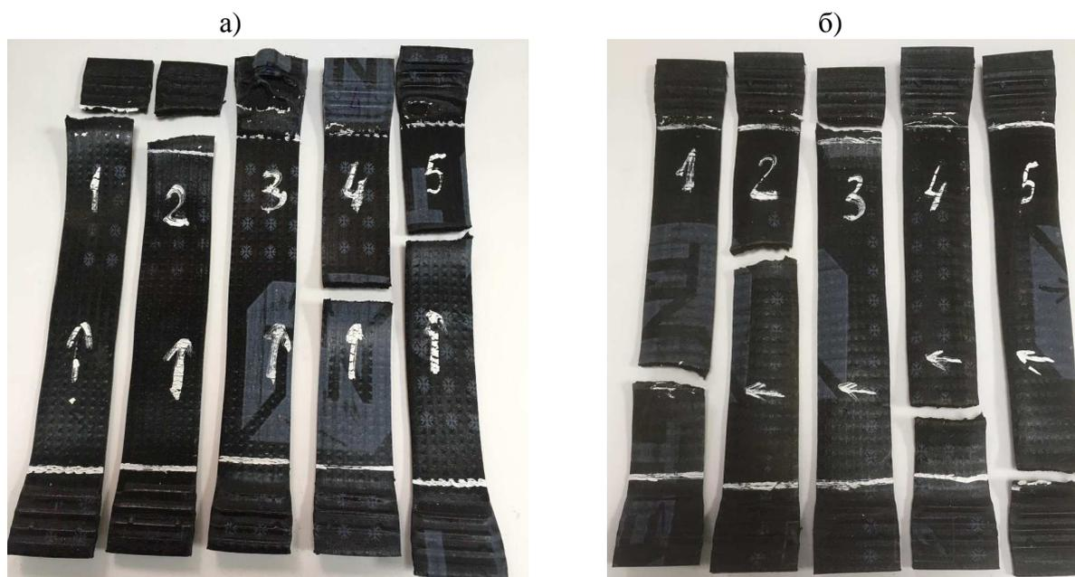
Рисунок 3 – Испытанные образцы рулонного гидроизоляционного материала ТЕХНОЭЛАСТМОСТ Б по определению его деформативно-прочностных показателей в продольном направлении (а) и в поперечном направлении (б)
