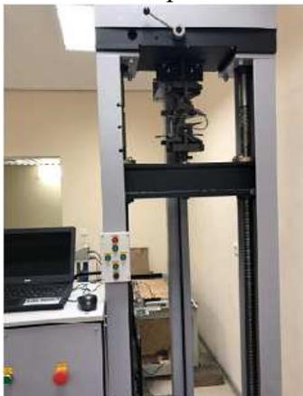
Машина для испытания конструкций И 11М мод. И 1147М-10-02-1 (свидетельство о поверке № 4612-П03/22 до 16 февраля 2023 г.).
