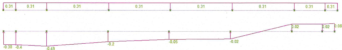
Рис. 25. Схема приложения нагрузка на балку: а – нагрузка от собственного веса кровли, б – ветровая нагрузка
