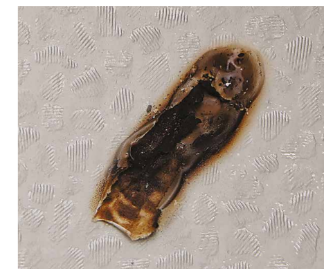
Образец мембраны толщиной 1,5 мм после проведения испытания.
