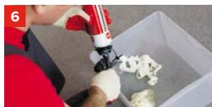
Отверните регулировочный винт пистолета, нажав на спусковой крючок, стравите некоторое количество пены в контейнер.
