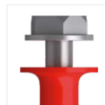
Бортик дюбеля предотвращает мостик холода
