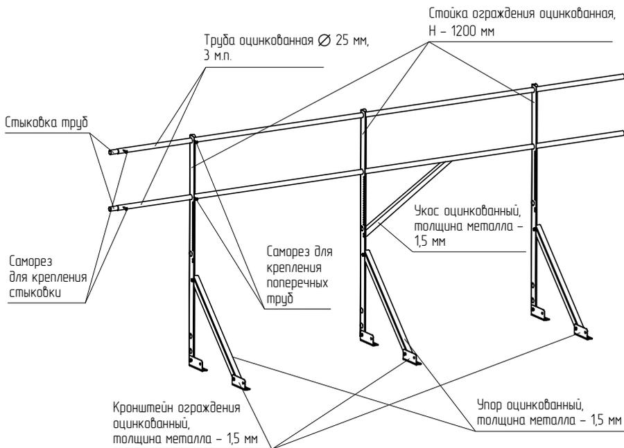
Универсальное кровельное ограждение, применяется для скатных и плоских кровель. Высота ограждения – 1200 мм, длина набора – 3 м. п., расстояние между ригелями – 300 мм. За счет имеющих отверстий в нижней части стоек ограждения можно дооснастить снегозадержанием, добавив два ригеля ограждения Ø25 мм.
