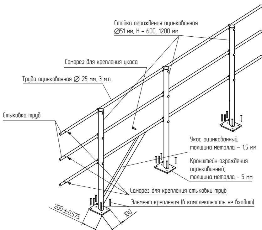
Крепление ограждения производится в ж/б плиту, цементно-песчаную стяжку, а также в антисептированный брус. Высота ограждения – 600 или 1200 мм, длина набора – 3 м.п., расстояние между ригелями – 300 мм.
