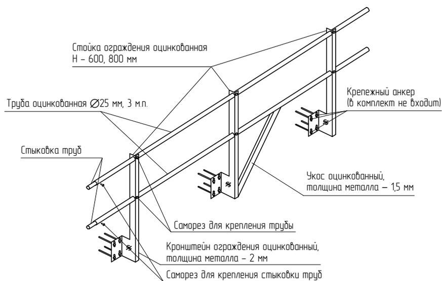
Крепление ограждения производится в вертикальную часть парапета. Высота ограждения – 600 или 800 мм, длина набора – 3 м.п., расстояние между ригелями – 300 мм.
