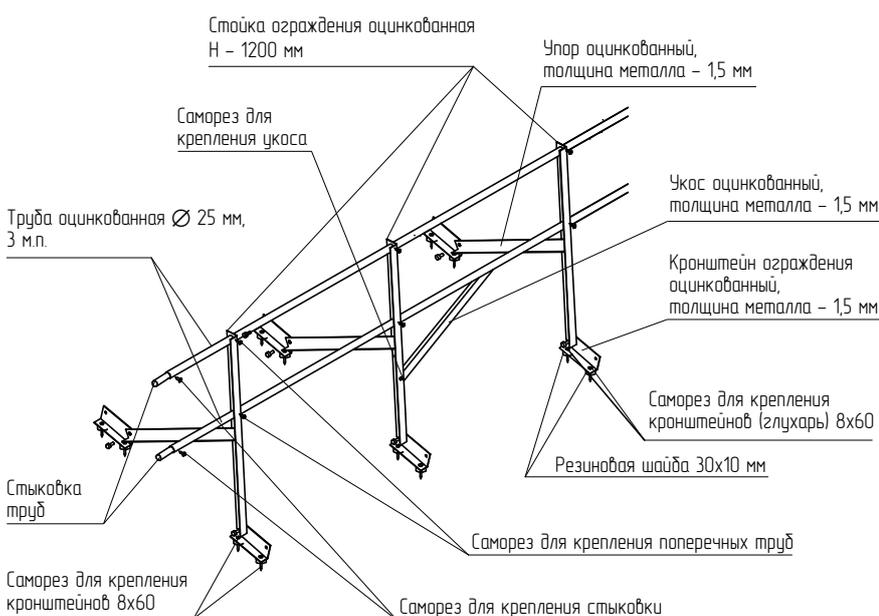
Универсальное кровельное ограждение для скатных и плоских кровель. Не имеет снегозадержания. Высота ограждения – 1200 мм, длина набора – 3 м. п., расстояние между ригелями – 300 мм.
