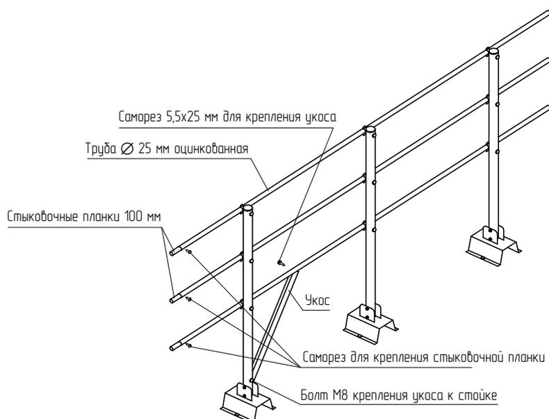
Крепление ограждения производится в профилированный лист\*. Высота ограждения – 800 или 1200 мм, длина набора – 3 м.п., расстояние между ригелями – 300 мм.
