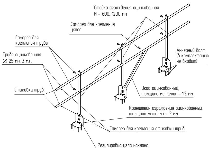
Крепление ограждения производится в горизонтальную часть парапета. Высота ограждения – 600 или 800 мм, длина набора – 3 м.п., расстояние между ригелями – 300 мм.
