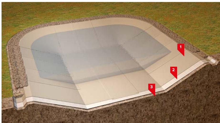
1. Гидроизоляционная мембрана ECOBASE V-UV
