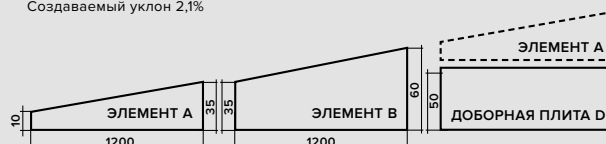
Плиты А и В. Создаваемый уклон 2,1%
