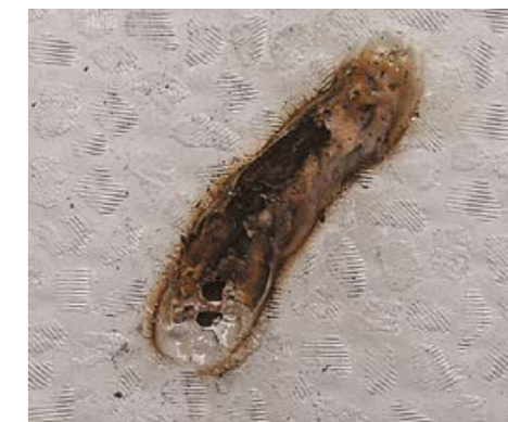
Образец мембраны толщиной 1,2 мм после проведения испытания.
