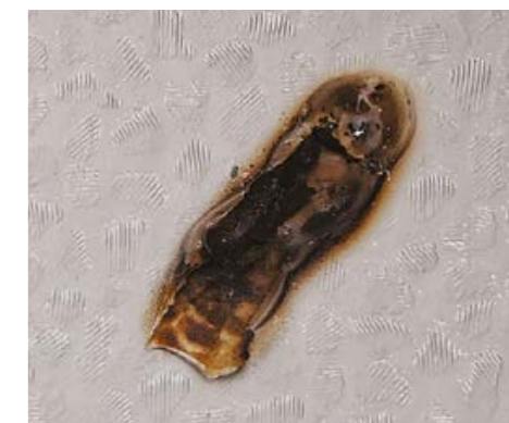
Образец мембраны толщиной 1,5 мм после проведения испытания.
