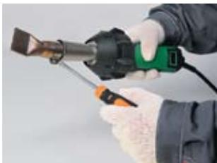
**ВАЖНО!** Всегда начинайте работы с выполнения пробной сварки, чтобы настроить оборудование в условиях конкретного объекта.
