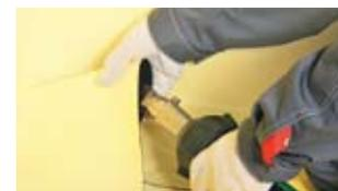
Подогните заваренный «карман» и приварите его к горизонтальному нахлесту при помощи узкого латунного ролика.
