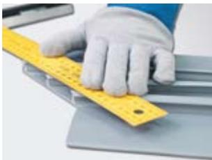
Углы скругляйте с обеих сторон. Это придаст удобство сварке плоских частей и повысит герметичность соединения.
