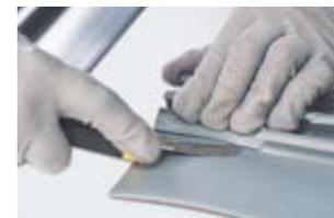
После того как ребра удалены, обязательно скруглите острые углы. Заготовка **2** готова.
