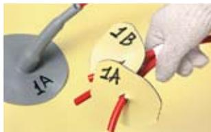
Маркируйте трубки в соответствии с маркировкой штуцеров, с которыми они соединены.
