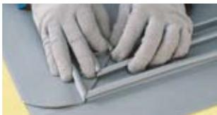
Отметьте на заготовке **2** места начала и окончания заготовки **1**.
