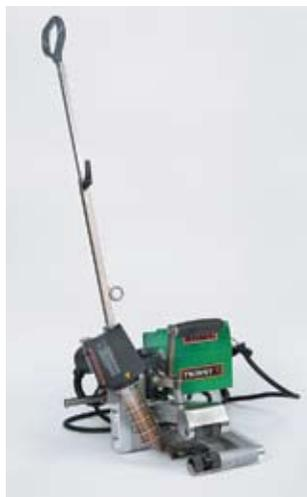
Для сварки мембраны на горизонтальных, наклонных и вертикальных поверхностях используйте автоматические сварочные аппараты «Twinni-T» и «Twinni-S» производства компании Leister.
