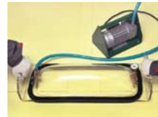
Включив вакуумный компрессор создайте в вакуумной камере разрежение до **2,0 МПа** на протяжении не менее **15 сек.**, после чего отключите компрессор. В некачественно проваренных местах появятся мыльные пузыри.
