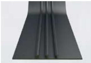
На одной из поверхностей шпонки по всей длине расположены анкерные элементы. Шпонки привариваются при помощи горячего воздуха гладкой стороной к гидроизоляционной мембране с образованием замкнутых прямоугольных контуров. Рекомендованный размер одной секции не более **150 м²**. Во время заливки конструкции анкеры шпонок замоноличиваются в бетон.
