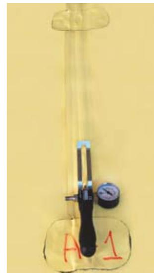
Для проверки герметичности шва введите иглу с манометром в пространство воздушного канала. Для этого слегка разогрейте ручным аппаратом поверхность шва, в которую намечен ввод иглы.
