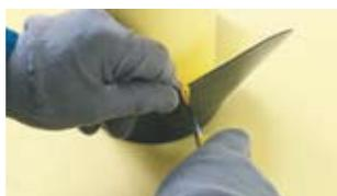
**ВАЖНО! Обязательно скруглите острые углы, образовавшиеся в результате реза заготовки.**
