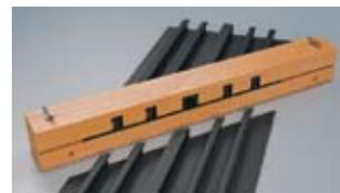
Установите нагревательный элемент в рабочее положение между концами гидрошпонок. Плавнo сомкните кондуктор, подводя концы гидрошпонки к нагревательному элементу. При этом вдоль всего периметра среза шпонки образуется валик из расплавленного материала. Следите за тем, чтобы оплавление происходило равномерно.
