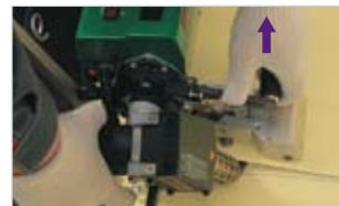
Выньте сопло аппарата из нахлеста, слегка потянув его в сторону по направляющей. Остановите движение ведущих роликов нажатием кнопки «М».
