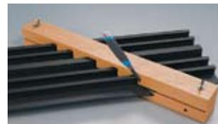
Разожмите кондуктор и вставьте шпонку таким образом, чтобы она немного высывалась из кондуктора, и снова зажмите.
