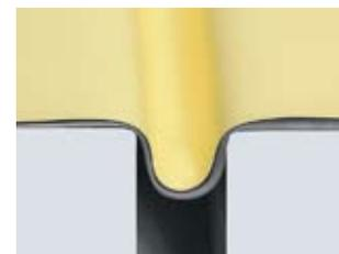
В созданную петлю в качестве компенсатора уложите Вилатерм соответствующего диаметра.
