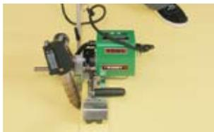
Выполните продольные и поперечные швы автоматическим аппаратом с образованием проверочного канала.
