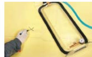
Далее следует произвести проверку на смежном участке шва. Для этого переставьте вакуумный колпак дальше по шву с перекрытием уже проверенного участка на **10–20 мм** и повторите проверку снова. Таким образом следует проверить шов по всей длине.
