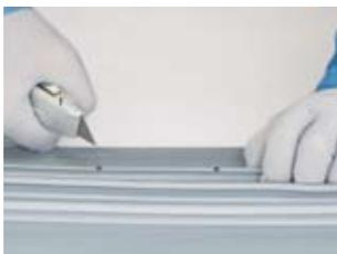
Разместите первую заготовку в месте удаленной части ребра второй заготовки для последующей приварки. Если необходимо, выполните подрезку заготовок по месту.
