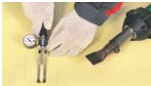
После окончания проверки герметичности швов выполните секционирование гидроизоляции и монтаж инъекционной системы. Подробнее см. п. 5.1.4. и 5.1.5.
