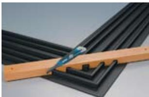
Зафиксируйте выполненные детали в специальном кондукторе для крестообразных стыков. Установите нагревательный элемент в рабочее положение между концами гидрошпонок. Плавно сомкните кондуктор, подводя концы гидрошпонок к нагревательному элементу. При этом вдоль всего периметра среза шпонки образуется валик из расплавленного материала. Следите за тем, чтобы оплавление происходило равномерно.
