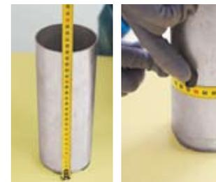
Одна сторона прямоугольника равна длине окружности трубы **+50 мм**, а вторая равна длине гильзы **+100 мм**. Выполните необходимые замеры и раскрой материала для заготовки.
