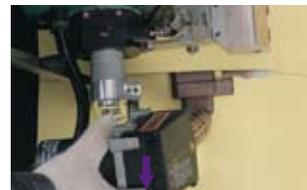
**ВАЖНО!** Не допускайте движения ведущих прижимных роликов в зажатом состоянии без материала.
