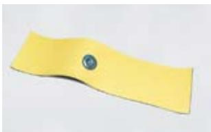
Зафиксируйте полосы механически через геотекстиль на вертикальной поверхности стены, отступив **7 см** от края полосы. Свободный конец полосы при этом направлен вверх.
