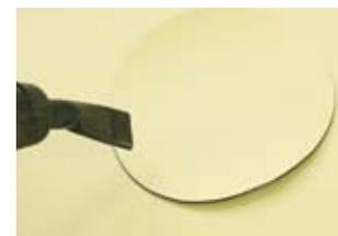
Обязательно подогревайте заплатки перед установкой, примеряя их по месту и придавая необходимую форму. Это значительно облегчит процесс приварки заплатки и повысит надежность соединения.
