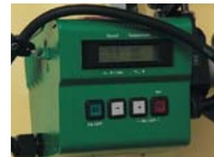
Перед началом сварочных работ выставьте параметры (температуру воздуха, скорость движения сварочного аппарата и давление прижимных роликов). Подробно о подборе параметров сварки см. п. 3.3.1.
