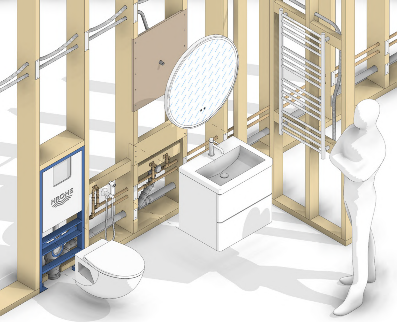
Рисунок 20. Дополнительные опорные стойки и распорки в стеновой панели
