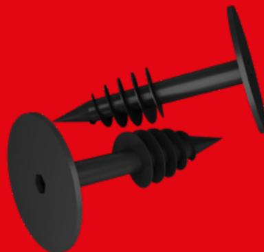
Винтовой крепеж TERMOCLIP с тарельчатым элементом диаметром 50 мм применяется для крепления нового слоя гидро- и теплоизоляционного материала к слабонесущему основанию как при новом строительстве, так и при проведении ремонтных работ. Элемент отлично подходит для скрепления слоев теплоизоляции, в том числе и для мягкой изоляции пониженной плотности.
