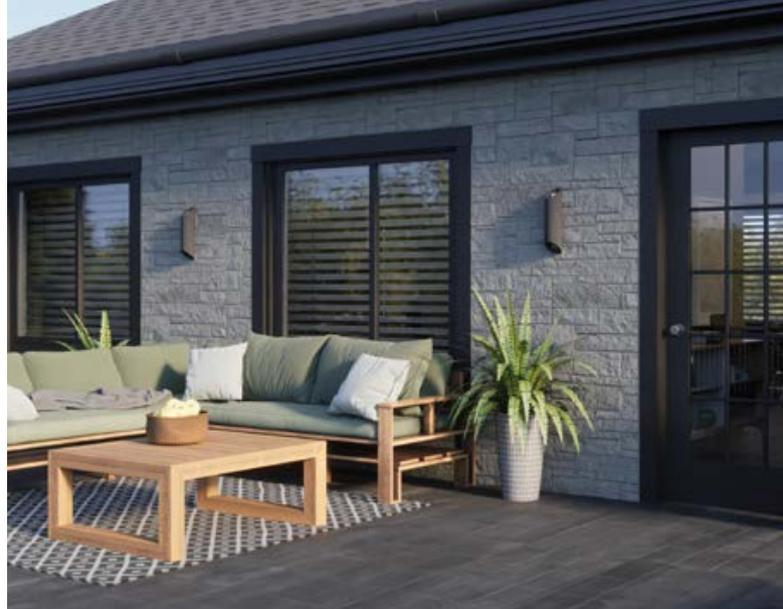
Фасадные панели изготавливаются из современного полимера на основе полипропилена. Этот материал устойчив к механическим и ударным нагрузкам, воздействию перепадов температур и ультрафиолета. Сухой способ монтажа и удобные доборные элементы ускоряют процесс и сохраняют чистоту на участке.
