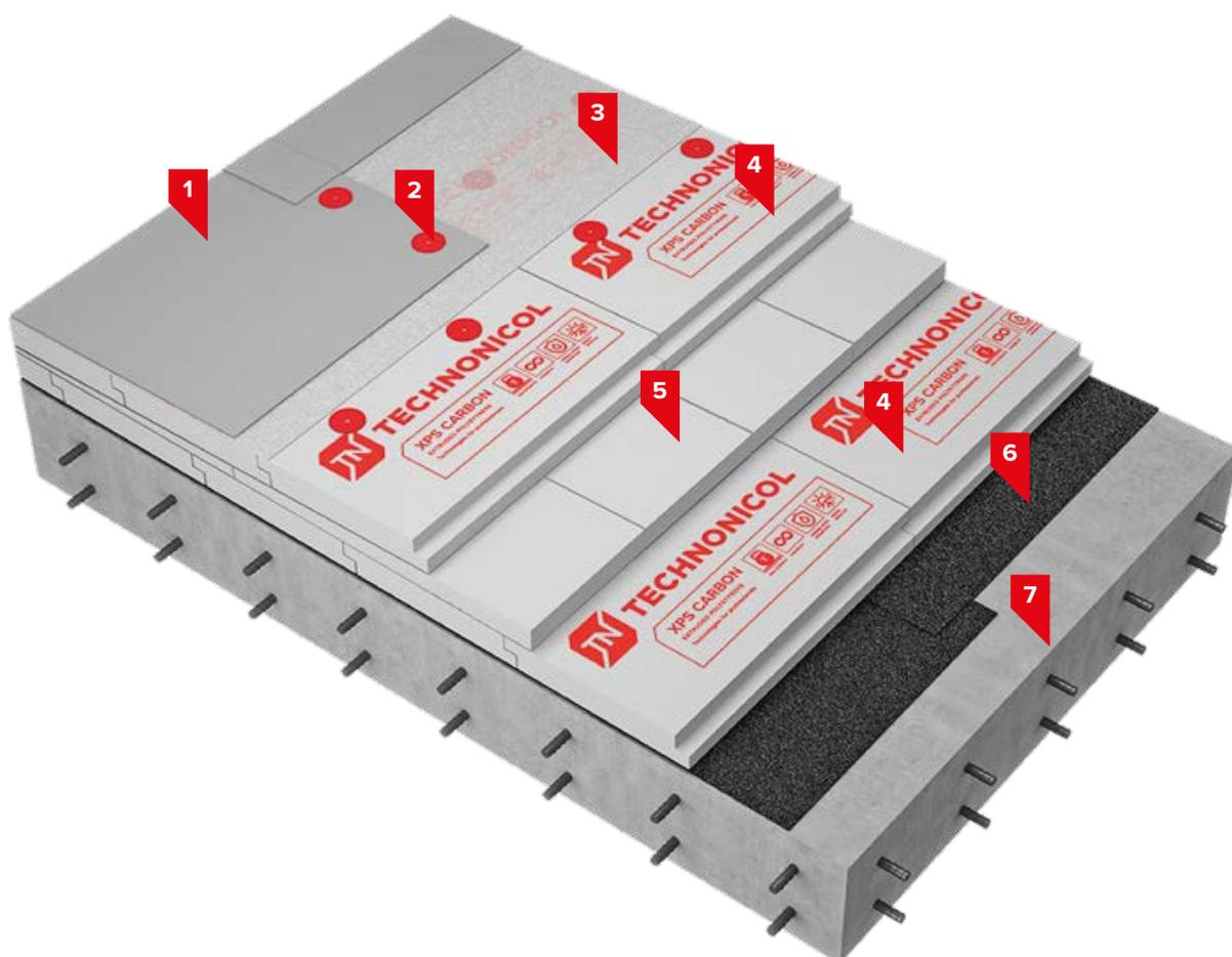
1. Полимерная мембрана LOGICROOF V-RP 1,5 мм
