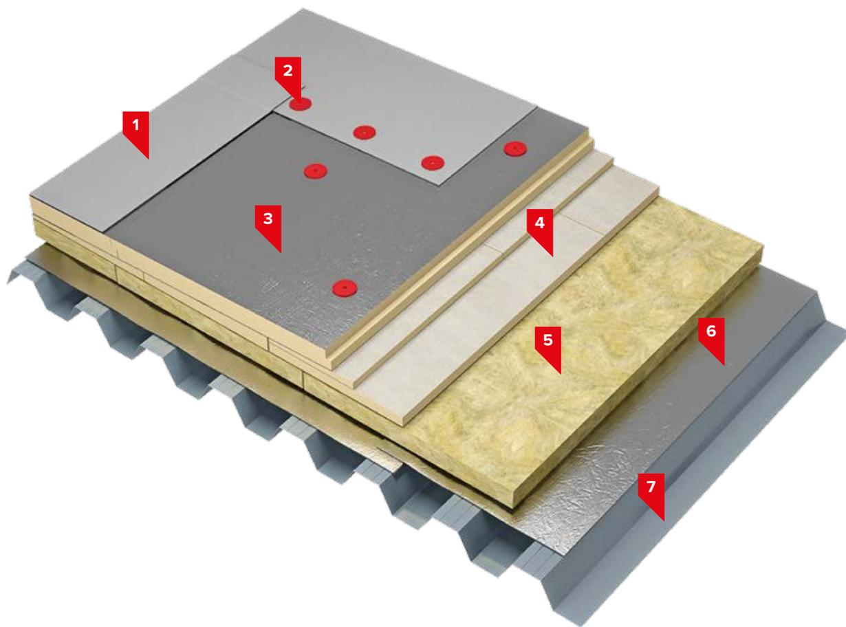
1. Полимерная мембрана LOGICROOF V-RP 1,5 мм
