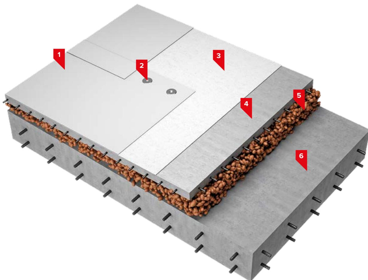
1. Полимерная мембрана LOGICROOF V-RP 1,5 мм
