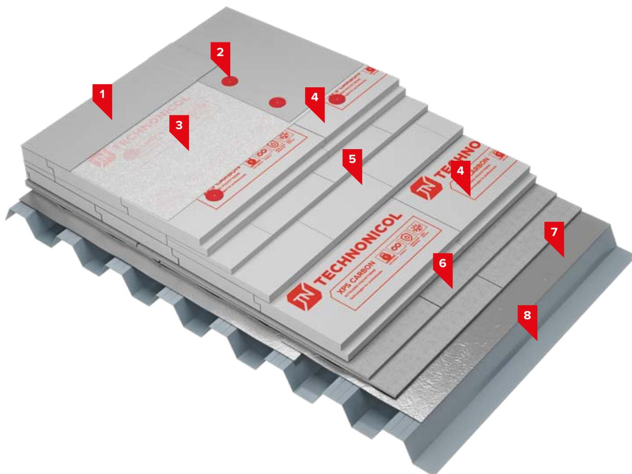
1. Полимерная мембрана LOGICROOF V-RP 1,5 мм
