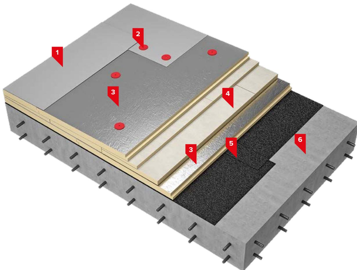
1. Полимерная мембрана LOGICROOF V-RP 1,5 мм
