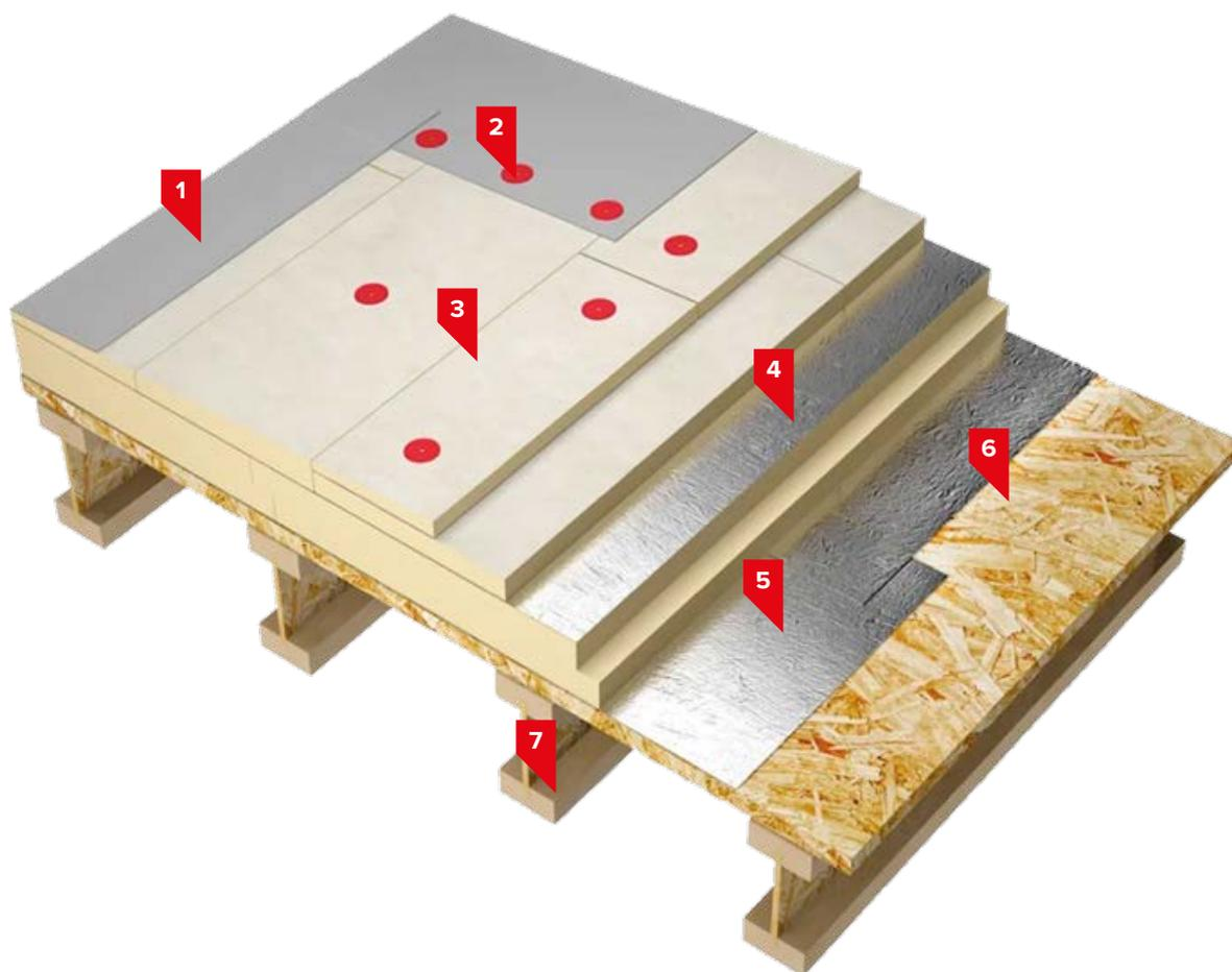
1. Полимерная мембрана LOGICROOF V-RP 1,5 мм
