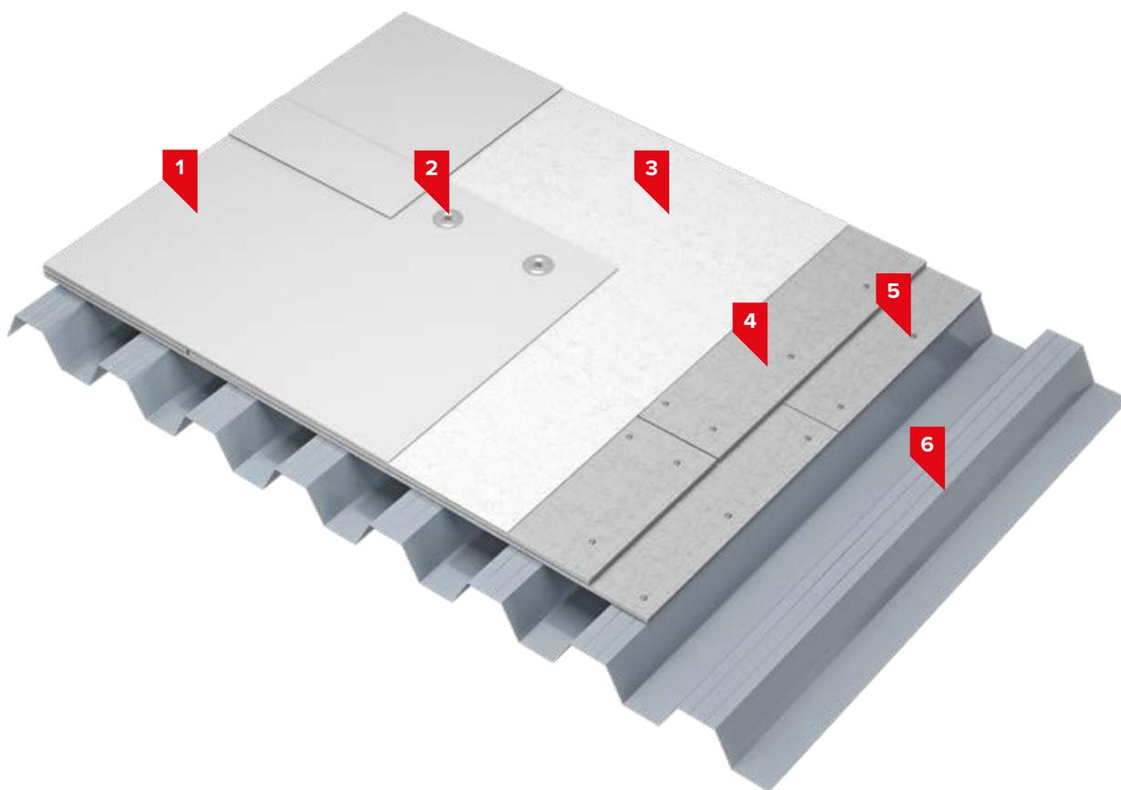
1. Полимерная мембрана LOGICROOF V-RP 1,5 мм
