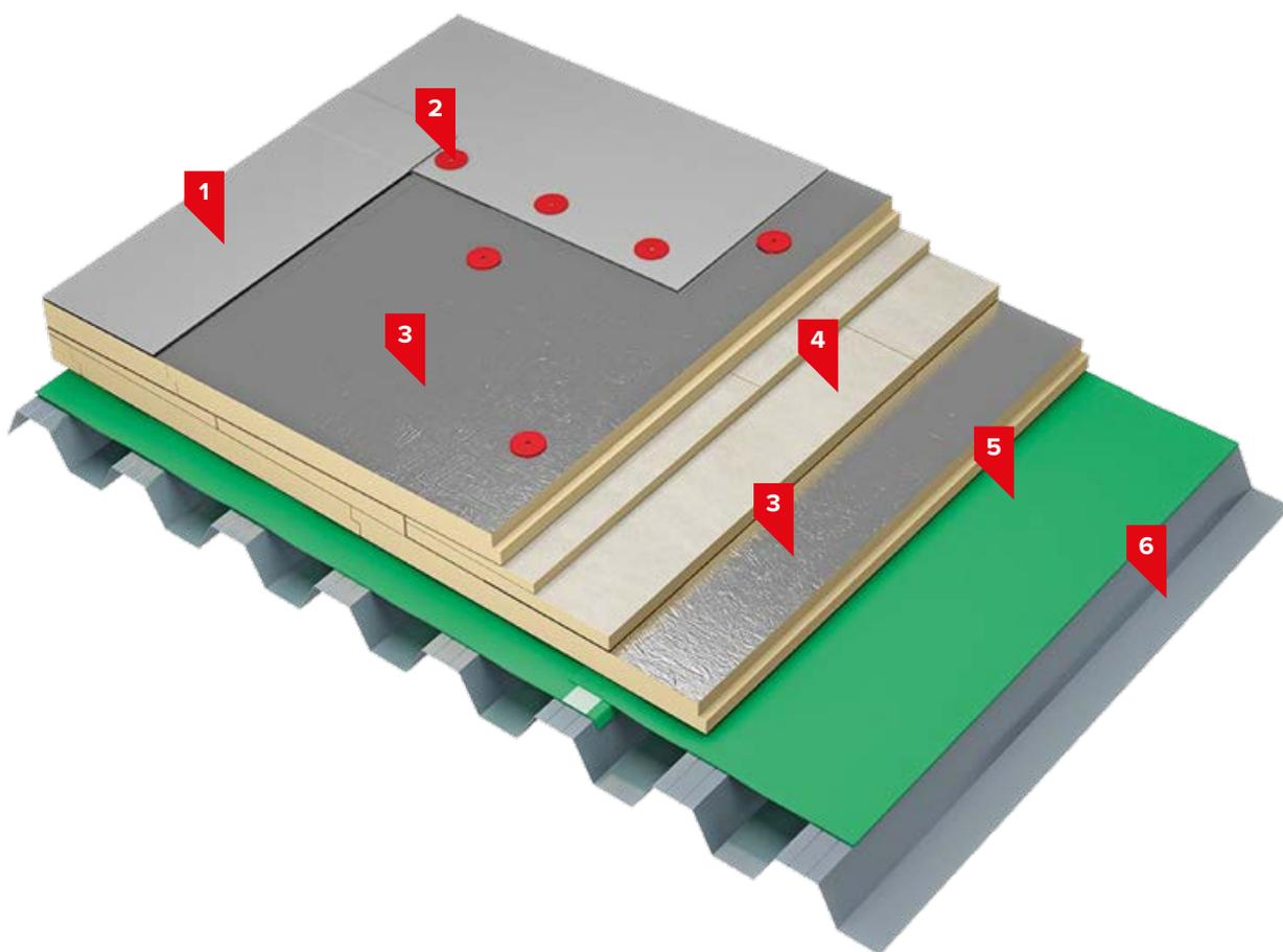
1. Полимерная мембрана LOGICROOF V-RP 1,5 мм
