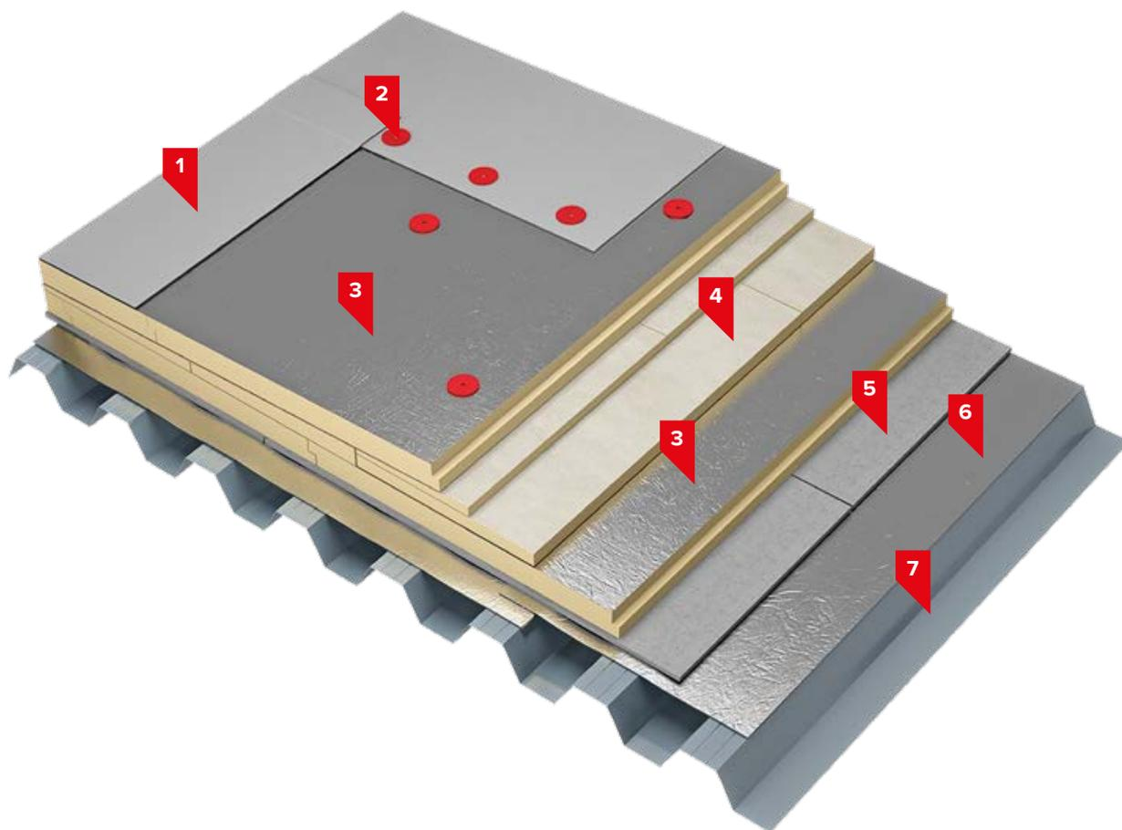
1. Полимерная мембрана LOGICROOF V-RP 1,5 мм
