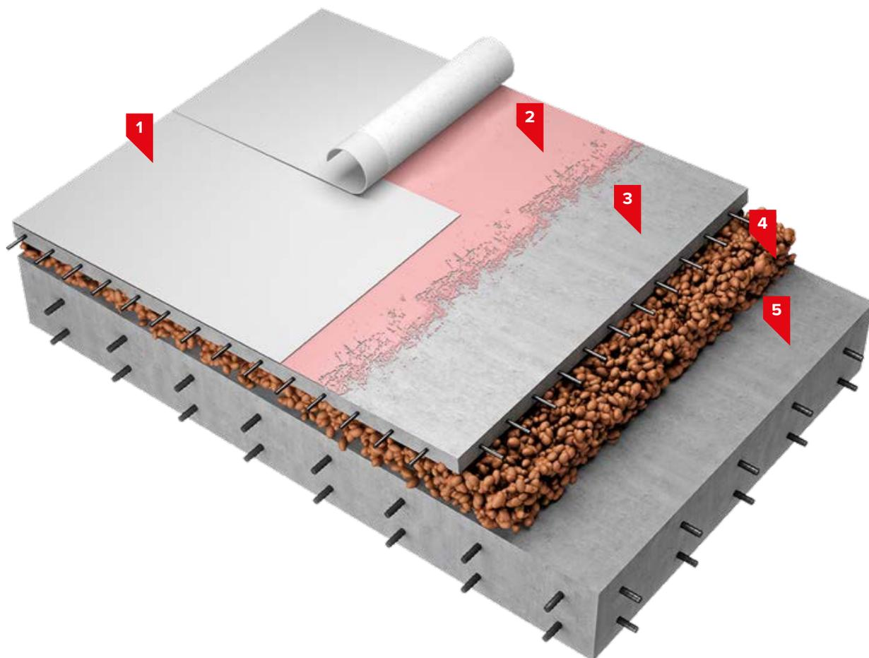
1. Полимерная мембрана LOGICROOF V-GR FB 1,5 мм
