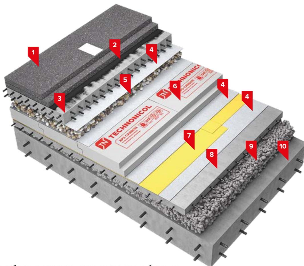
1. Асфальтобетон на вяжущем дорожном полимерно-битумном
