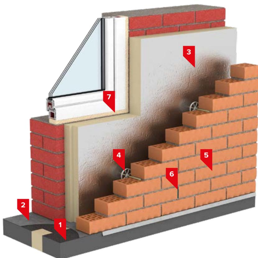
1. Опорное перекрытие с «термовкладышами» из LOGICPIR Ф/Ф
