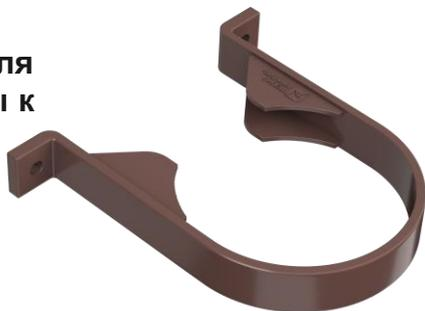
Хомут трубы универсальный предназначен для крепления водосточной трубы на необходимом от фасада расстоянии. Идет в комплекте с дюбелем 140 или 180 мм.
